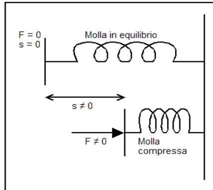
Facendo riferimento alla figura precedente, se la forza applicata ad una molla è nulla, la molla è in equilibrio e non è caratterizzata da alcuna deformazione geometrica. Applicando una forza  $\vec{F}$  per comprimerla e misurando la deformazione  $\vec{s}$ , si può verificare la legge di Hooke: la deformazione  $\vec{s}$  è direttamente proporzionale alla forza applicata  $\vec{F}$ :
