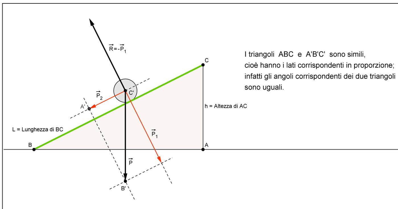
Ovviamente  $\vec{P} = \vec{P}_1 + \vec{P}_2$ . Poiché il moto avviene solo parallelamente al piano, la reazione  $\vec{R}$  dovrà essere l'opposto del vettore  $\vec{P}_1$ , dunque:
